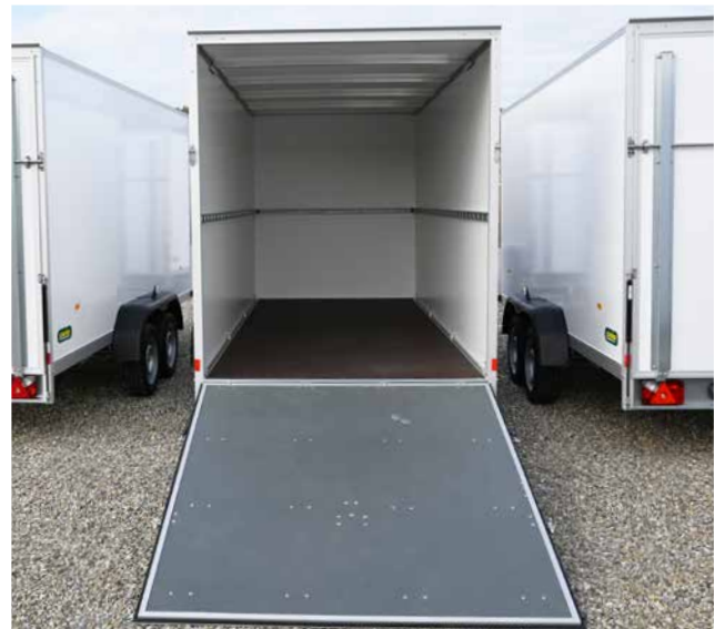
Auffahrklappe mit rutschhemmender Oberfläche
